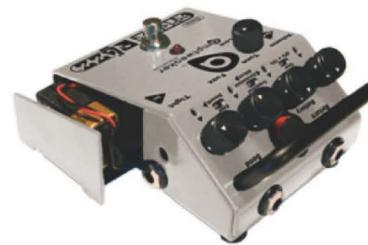
**Compartiment à pile** – fermé par aimantation, il peut être ouvert en tirant sur les côtés
