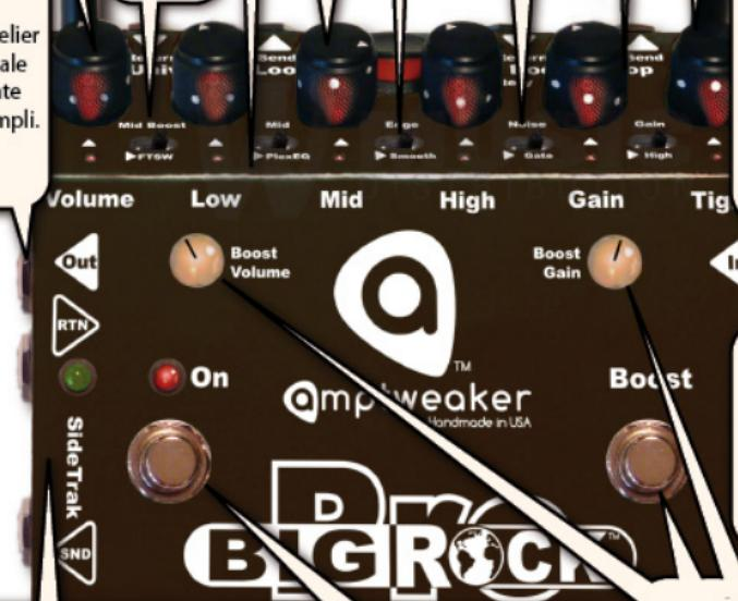
**SideTrak Loop** - cette boucle est active quand la BR PRO est bypassée. Send sur entrée « clean effects », Return sur sortie « clean effects ».
