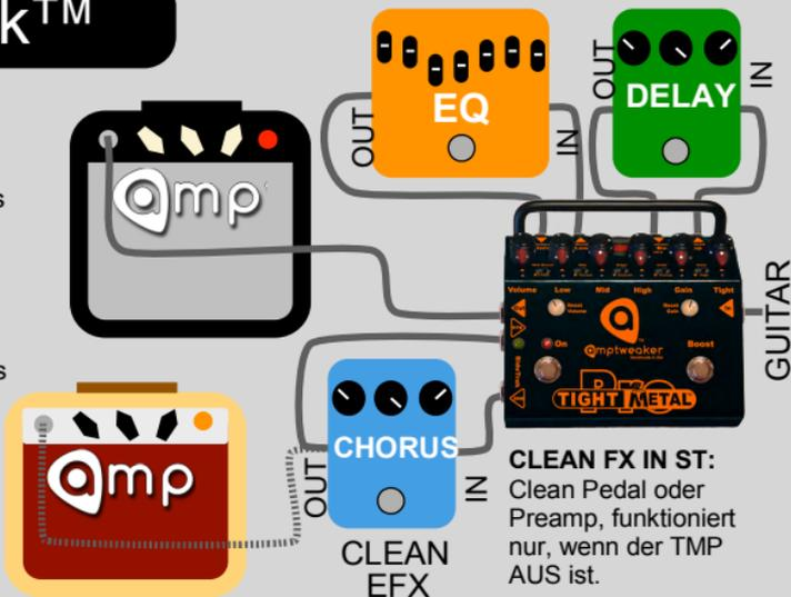
**CLEAN FX IN ST:** Clean Pedal oder Preamp, funktioniert nur, wenn der TMP AUS ist.
