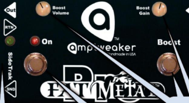
**SideTrak Loop** - cette boucle est active quand la FM PRO est bypassée. Send sur entrée « clean effects », Return sur sortie « clean effects ».
