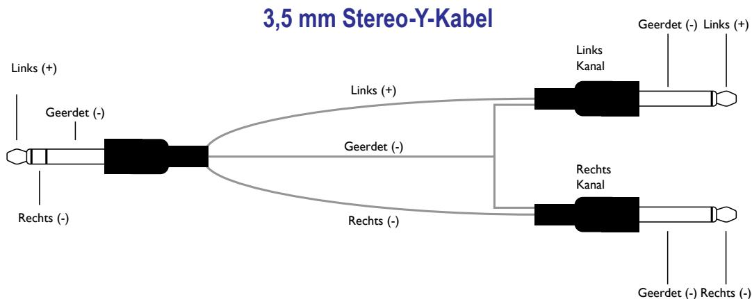
**HINWEIS:** Der 6,35 mm Ausgang muss für diese Art Setup für den Stereo-Betrieb konfiguriert werden. Siehe „Mono-/Stereo-Betrieb“ auf Seite 21 für weitere Informationen.
