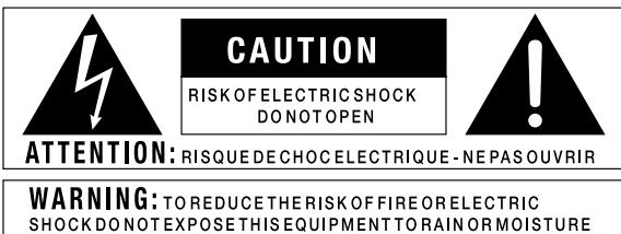
Die obigen, international anerkannten Symbole sollen Sie vor möglichen Gefahren durch Elektrogeräte warnen. Der Blitz in einem Warndreieck bedeutet, dass gefährlich hohe Spannung im Innern dieses Geräts vorliegt. Das Ausrufezeichen in einem Warndreieck zeigt dem Benutzer, dass er das Bedienungshandbuch konsultieren sollte.
