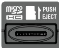
1. Stecken Sie die Speicherplatte vollständig mit nach unten weisenden Kontakten in den Kartensteckplatz und drücken Sie, bis die Karte fest im Steckplatz sitzt.
