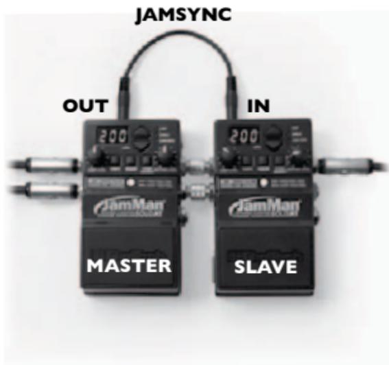
Zur Verwendung von JamSync verbinden Sie die **JAMSYNC OUT**-Buchse des Master JamMan Solo XT mit der **JAMSYNC IN**-Buchse des ersten Slavegeräts. Schalten Sie alle restlichen JamSync-Slaves auf dieselbe Weise in Reihe.
