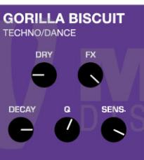
\* PASSEN SIE MIT DEM SENS.-REGLER DEN EFFEKT AN DEN AUSGANGSPEGEL IHRES INSTRUMENTS AN
