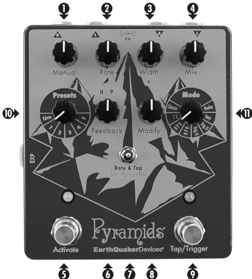
**1 Manual (manuel) :** Contrôle la durée de délai du signal modulé. Tournez la commande dans le sens horaire pour une durée de délai plus courte et un son de flanger plus aigu. Tournez la commande dans le sens anti-horaire pour une durée de délai plus longue et un son de flanger plus grave. Ce paramètre peut être contrôlé en utilisant une pédale d'expression. Si une pédale d'expression est utilisée, la commande Manual est désactivée.
