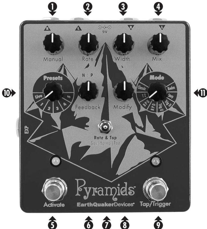
**1 Pokrętło Manual:** Kontroluje czas delay modulowanego sygnału. Przekrć je w prawo dla krótszego czasu delay oraz brzmienia flanger w wyższej tonacji. Przekrć je w lewo dla dłuższego czasu delay oraz brzmienia flanger w niższej tonacji. Parametr ten może być także sterowany poprzez pedał ekspresji. Podczas używania pedału ekspresji, pokrętło manual będzie nieczynne.
