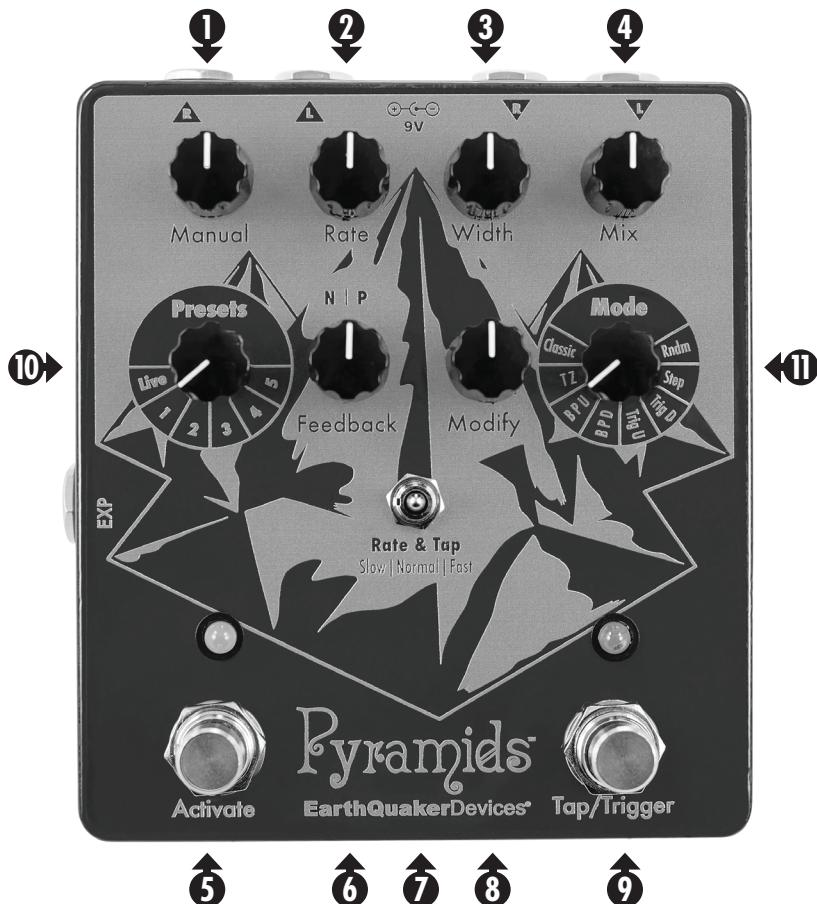
**1 Manual:** Controlla il tempo di ritardo del segnale modulato. Ruota in senso orario per ritardi più brevi ed una sonorità flange più acuta. Ruota in senso antiorario per ritardi più prolungati ed una sonorità flange più grave. Questo parametro può essere controllato mediante un pedale d'espressione. Utilizzando un pedale d'espressione, il controllo Manual viene escluso. Il controllo Manual di Pyramids può anche essere modulato da una sorgente CV da 0-3V.
