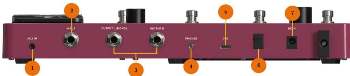
1. **AUX IN:** 3,5 mm Stereo TRS Audioeingangsbuchse für den Anschluss einer externen Audioquelle (Mobilgerät, Audiogerät) für Übungszwecke.
