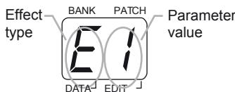
**Typ und Parameter:** Der Effektyp (links auf dem Display) und der Wert des Parameters (rechts auf dem Display) werden gleichzeitig eingestellt.
