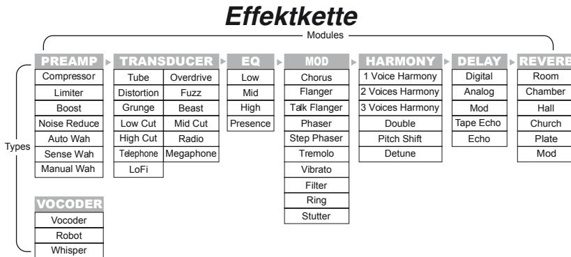
Die VEM Box besitzt 8 Effektmodule, insgesamt 54 Effekttypen, von denen bis zu 7 gleichzeitig verwendet werden können (das Vocoder kann nicht mit anderen Modulen zusammen verwendet werden).
