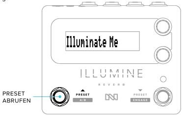
Wenn der A/B Schalter als Expression Eingang eingestellt ist (siehe Expression-Control Funktion) schaltet ein längerer Druck (>650 ms) auf den linken Fußschalter zwischen den Parameter-Sets A und B um.
