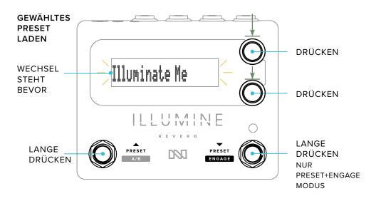
Da diese Option dem Preset-Fußschalter eine sekundäre Option für langen Druck hinzufügt, werden die Änderungen erst beim Loslassen des Schalters ausgeführt (Siehe Betätigung S. 10).
