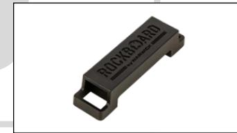
Pour détacher votre système QuickMount®, nous vous recommandons l'outil **RockBoard® QuickMount® QuickRelease Tool**. Il suffit de place le QuickRelease Tool sur les pinces à l'arrière du pedalboard et appuyez vers le bas. Ce petit outil utile appuiera simultanément sur les pinces des deux côtés pour que vous puissiez retirer les pédales de votre pedalboard rapidement et facilement.
