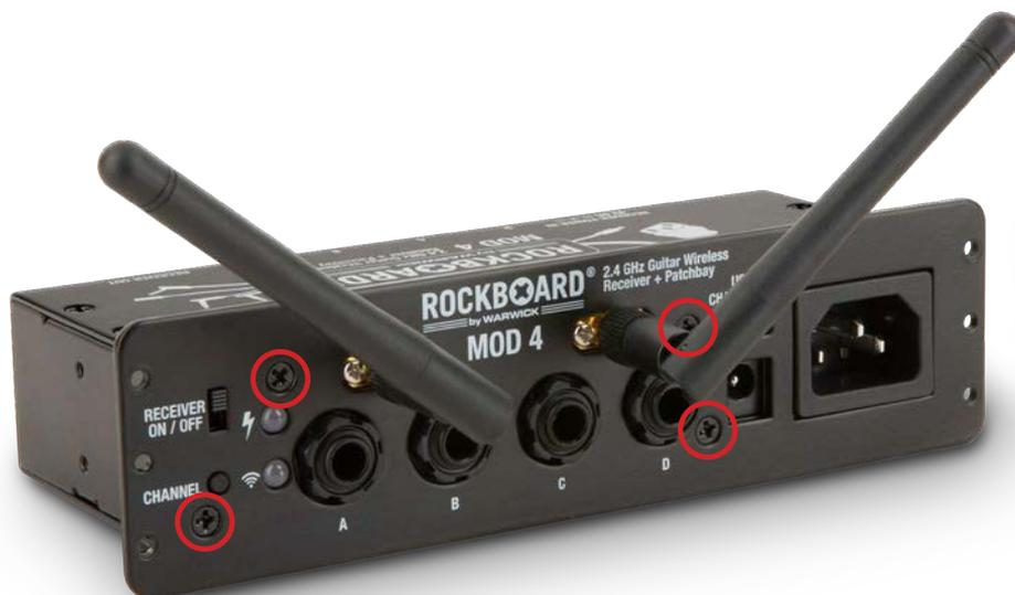
Retirez les vis comme indiqué ci-dessous pour détacher la plaque avant de votre MOD en utilisant un tournevis cruciforme à tête PH2. Les écrous de montage de la prise jack n'ont pas besoin d'être retirés.
