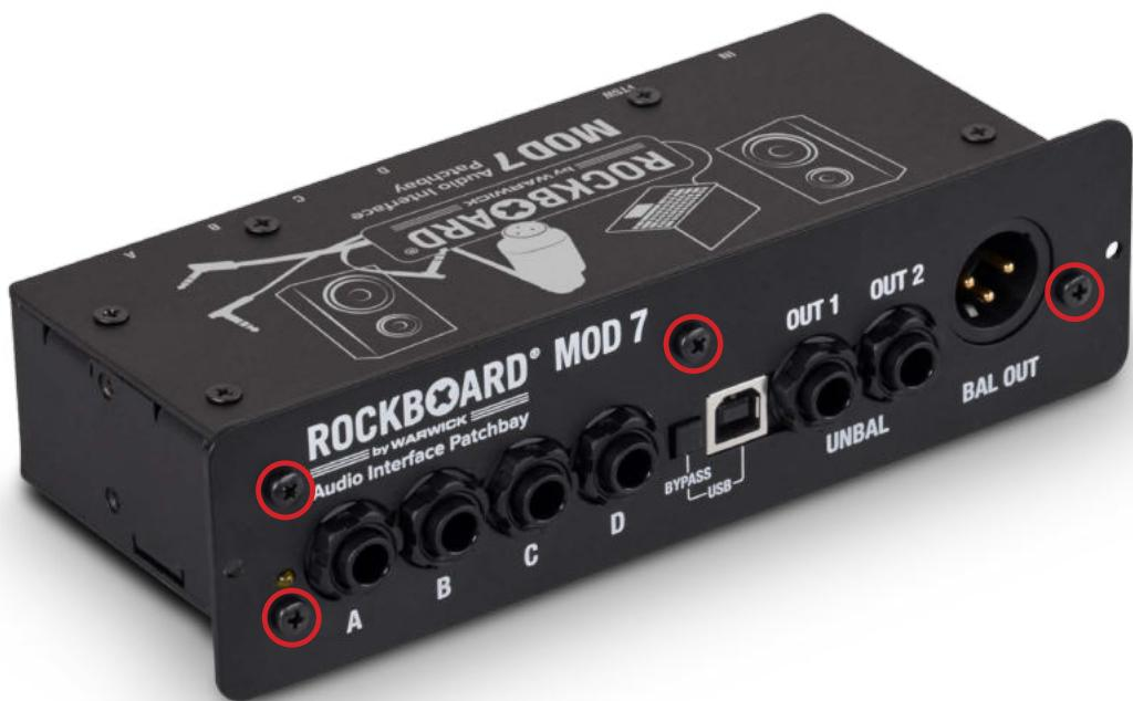
Retirez les vis comme indiqué ci-dessous pour détacher la plaque avant de votre MOD en utilisant un tournevis cruciforme à tête PH2. Les écrous de montage de la prise jack n'ont pas besoin d'être retirés.
