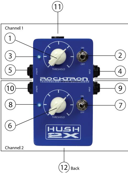
1. **KANAL 1** - Der THRESHOLD Regler (Schwellwert) bestimmt den minimalen Eingangspiegel, bei dem der HUSH Filter und Downward-Expander zu arbeiten beginnt. Wird diese Einstellung zu hoch gesetzt, führt dies zu einem Sustain-Verlust, da Noten dann viel schneller als gewünscht unterdrückt werden. Bei zu niedriger Einstellung dagegen schließt der Expander zu spät (wenn überhaupt) und das Grundrauschen bleibt hörbar.
