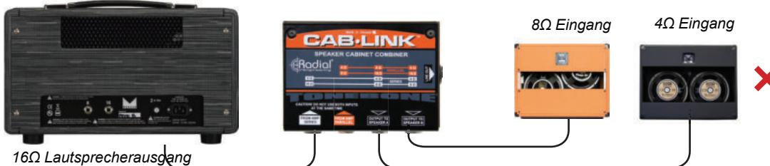
Wenn Sie die parallele Betriebsart nutzen, sinkt die Gesamtimpedanz (zwei parallel geschaltete 8 $\Omega$  Lautsprecherboxen bekommen dann eine Impedanz von insgesamt 4 $\Omega$ ). In Serie geschaltet erhöht sich die Impedanz (zwei in Serie geschaltete Lautsprecherboxen mit jeweils 8 $\Omega$  bekommen eine Gesamtimpedanz von 16 $\Omega$ ).
