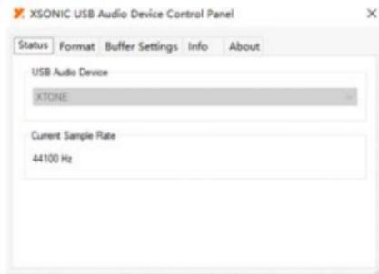
Sie können die Abtastrate (Sample) so hoch einstellen, wie Sie wollen. Die Puffergröße (Buffer Size – geringer bedeutet weniger Latenz) kann bis auf 8 Samples reduziert werden, sofern Ihr Computer dies verarbeiten kann. Viel Spaß mit einer niedrigen Latenz unter Windows! Wenn Sie statt einer extrem niedrigen Latenz ein stabiles Audio-Verhalten bevorzugen, aktivieren Sie bitte den "Safe Mode".
