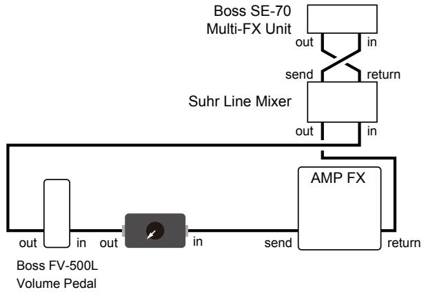
Wenn Dein Verstärker keinen Effekt-Loop besitzt, kannst Du den SVC auch vor den Amp schalten, jedoch nur zwischen deine Pedale und den Amp. Ist die Gitarre direkt an den SVC angeschlossen, tritt Höhenverlust auf:
