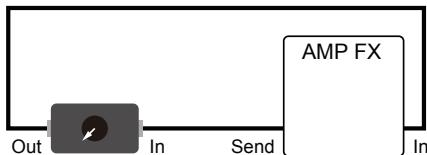
Wenn der SVC mit einem Low-Impedance-Effekt verwendet wird:
