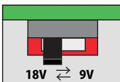
Wählt aus, ob das Pedal auf 9VDC oder 18VDC läuft. Im Vergleich zu 9V liefern 18V weniger Verzerrung und ein breiteres Frequenzspektrum, allerdings ist die Batterie sehr viel schneller leer. Ab Werk steht dieser Schalter auf 18VDC.
