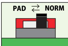
Mit dem internen DIP-Schalter 1 kann das Input-Level an die Gegebenheiten angepasst werden. Unter normalen Umständen sollte die „Norm“ -Einstellung keine ungewollte Verzerrung verursachen. Wenn man jedoch ein Instrument mit aktiven Tonabnehmern und höherem Output verwendet, kann man unschöne Verzerrungen durch die „Pad“ -Einstellung vermeiden. Ab Werk steht dieser Schalter auf „Normal“
