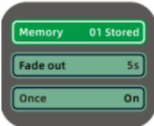
**Memory (Speicher):** Der Looper bietet 40 Speicherpositionen (von 1...40) für den Benutzer. "Stored" kennzeichnet eine belegte Position, "Empty" ist eine für die Speicherung verfügbare Position. Drehen Sie den LOOPER-Knopf, um durch die Positionen zu blättern. Verwenden Sie den SELECT Knopf, um die Position auszuwählen.
