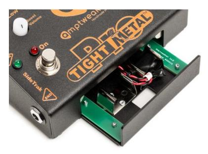
...das entsprechende Batteriefach ist auf der Vorderseite untergebracht und lässt sich leicht öffnen.
