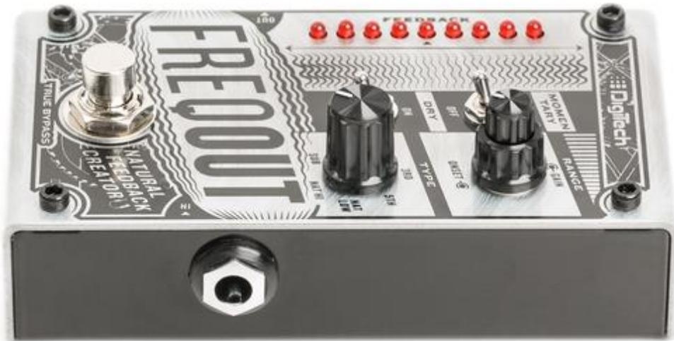
*Das Freqout muss als erstes Pedal direkt nach dem Instrument in der Signalkette platziert werden.*
