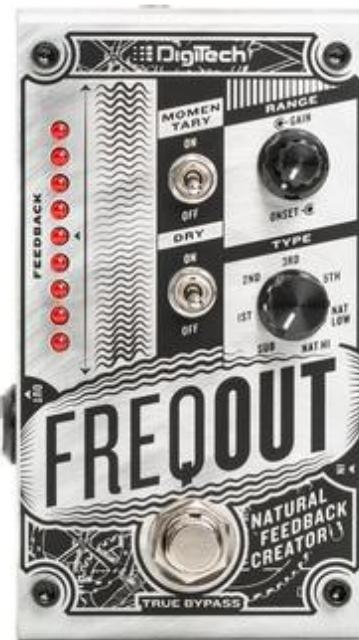
Auffälligstes Merkmal der Bedienoberfläche ist die Feedback LED-Kette auf der linken Seite.
