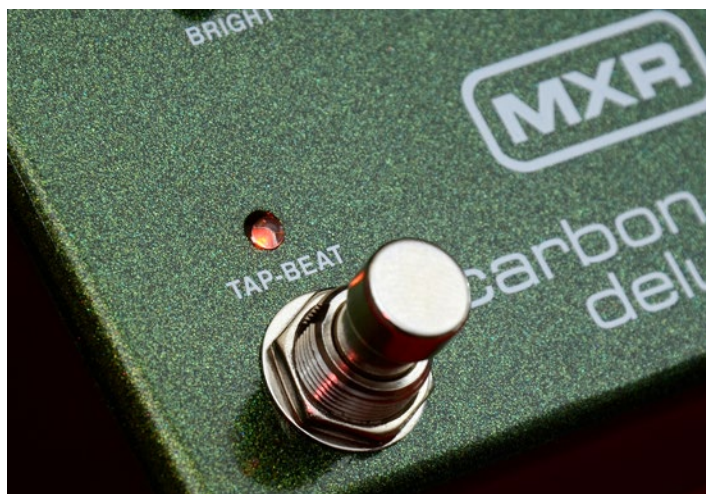
Przycisk Tap-Beat pozwala na nabicie tempa, bądź przełączanie pomiędzy dwoma presetami po podłączeniu zewnętrznego przełącznika tap tempa.
