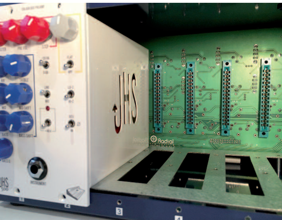
Slot-Buchsen zur Aufnahme einzelner 500er-Module im Inneren des Radial Modulrahmens
