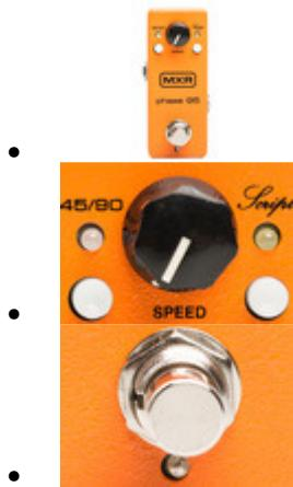
Angeschaltet wird der Effekt per Fußschalter, ausgeschaltet tritt eine True-Bypass-Schaltung in Aktion. Hier gibt es ebenfalls eine LED, allerdings ist diese hinter dem Schalter angebracht, sodass sie beim Schalten vom Fuß verdeckt wird. Weiter oben, über dem Logo, wäre sie besser platziert, aber das ist jetzt Meckern auf hohem Niveau, denn die beliebten alten Script-Logo-Phaser hatten überhaupt keine Kontrollleuchte.
