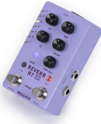
*Die Infinte-Funktion des Mooer R7 Reverbs verlängert bei Betätigung des entsprechenden Fußschalters die Hallfahne.*
