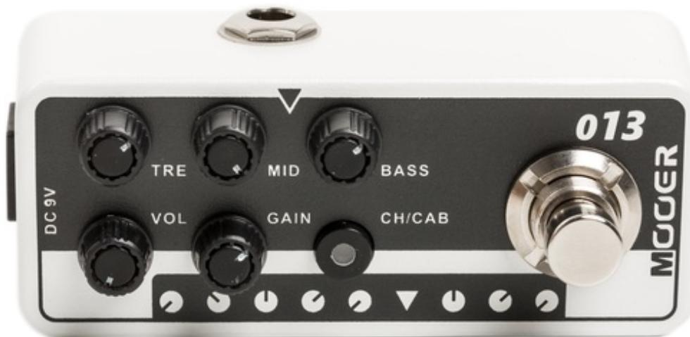
Auf dem Bedienfeld sind fünf Mini-Potis, ein Mini-Taster und der Fußschalter untergebracht.
