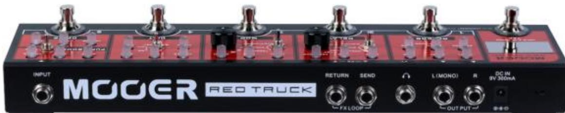
An der Stirnseite gibt es alles zu finden, was man für den Einsatz des **Red Truck** Live oder im Studio benötigt. Zunächst wäre da natürlich der Eingang für die Gitarre, raus geht es in Mono oder in Stereo oder aber man zapft das Signal an der Kopfhörerbuchse ab. Das hier anliegende Signal verfügt über eine Lautsprechersimulation, sodass der **Red Truck** ohne Umwege in den Computer bzw. in das Audiointerface eingeklinkt werden kann.
