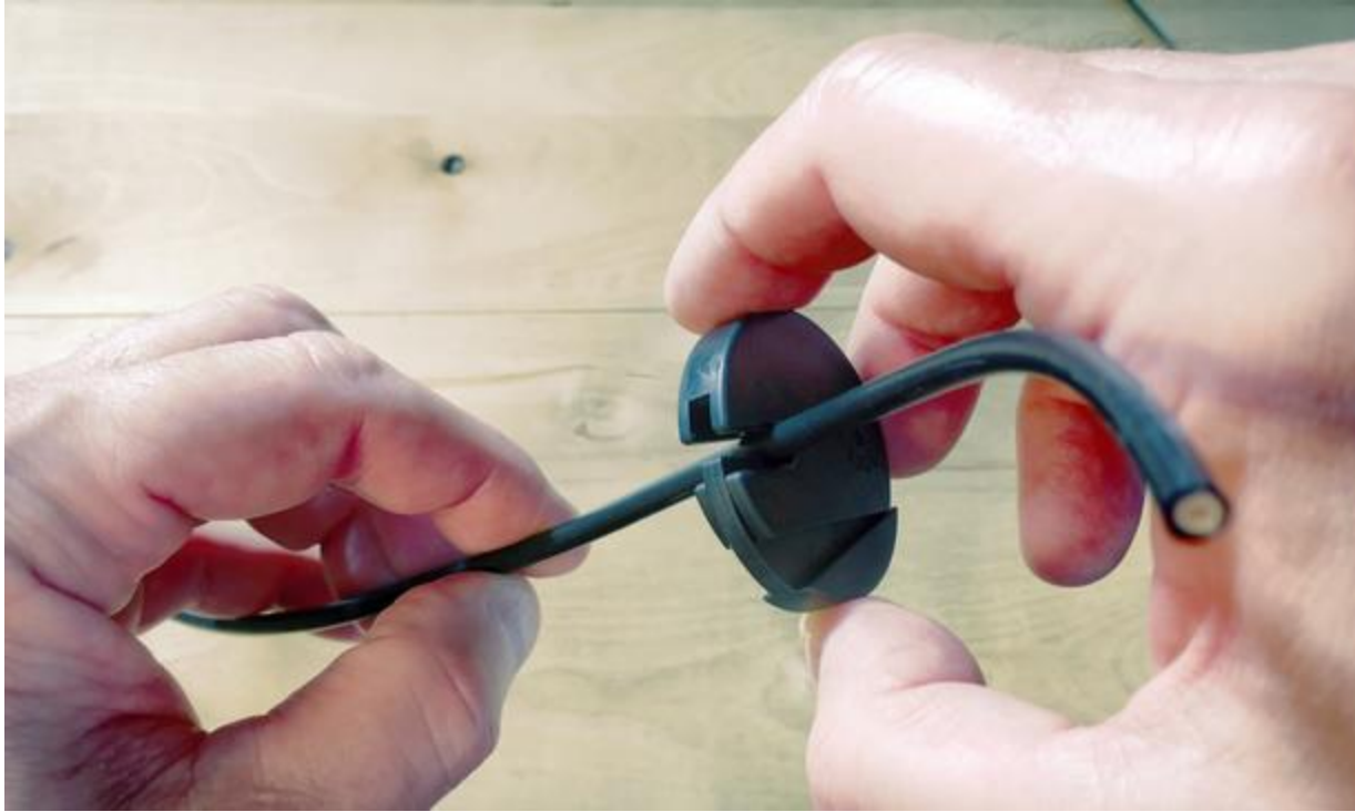
So wird das Kabel eingeführt...
