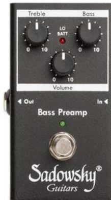
Die Einsatzfrequenzen des Sadowsky SPB-2 liegen bei 40 Hz für den Bassregler und bei 4 kHz für den Höhenregler. Aktiviert wird der Bodentreter mit einem standardmäßigen Fußtaster, der wie üblich auf der unteren Hälfte der Front sitzt.
