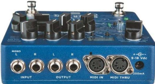
in zahlreichen Vintage-Gitarrenverstärkern zu finden ist. Hier steht eine Decay Time von 100 ms bis 5 Sekunden zur Verfügung, Pre-Delay wie gehabt mit 0-200 ms. Mit Hilfe der Regler Grit und Damp lassen sich recht authentische, leicht anzerrende Lo-Fi-Halleffekte erzielen.
