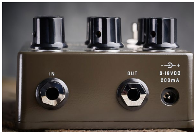
Na ścianie tylnej urządzenia znajdują się gniazda wejścia (IN), wyjścia (OUT) oraz złącze zasilania DC przyjmujące prąd o napięciu w zakresie 9-18 V.
