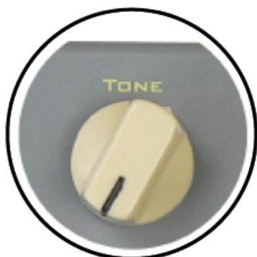
Le potentiomètre Tone de la Classic Optical Envelope est un filtre d'aigus. Complètement tourné dans le sens horaire, vous disposez de l'ensemble de la bande passante. En le tournant dans le sens antihoraire, vous commencez à filtrer les hautes fréquences. Sur cet effet, le réglage Tone interagit avec le réglage Drive. Ainsi, lorsque vous agissez sur le réglage Drive, vous devrez peut-être réajuster le réglage Tone pour obtenir un son optimal.
