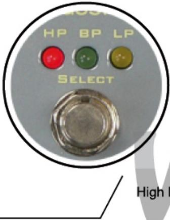
L'interrupteur Select permet d'accéder à trois présets différents : HP (High Pass), BP (Band Pass) et LP (Low Pass). Les sonorités de ces présets permettent d'obtenir des sons de wah généreuses typés années 60 et des sons plus acérés évoquant la disco des années 70... ainsi que toutes les nuances sonores intermédiaires. Le réglage Low Pass de la Classic Optical Envelope est également adapté aux guitares basses.
