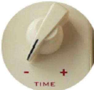
Im manuellen Modus (die LED über dem TEMPO-Schalter leuchtet nicht) stellst du die gewünschte Delay-Zeit mittels des Time-Reglers ein.
