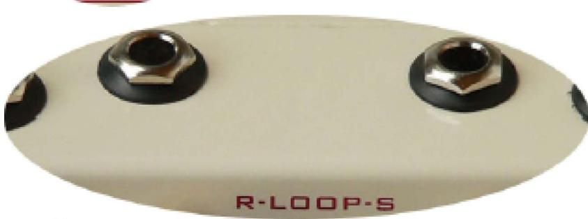
Über den LOOP kannst du externe Effektgeräte wie Chorus, Phaser, Verzerrer oder EQ in das Delay einschleifen. Damit hast du unzählige Möglichkeiten, die Echo-Wiederholungen (nicht den Gesamtsound der Gitarre) zu verändern und zu verfremden.
