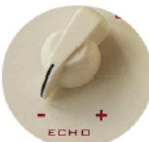
Mit dem ECHO-Regler bestimmst du das Verhältnis zwischen Dry- und Wet-Signal. Drehen im Uhrzeigersinn erhöht den Effekt-Anteil.
