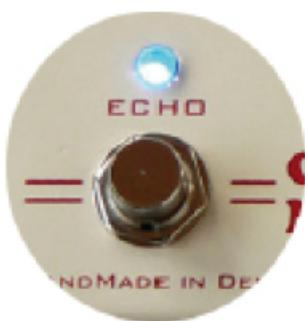
Le switch ECHO active ou bypass l'Echotone. La LED s'allume lorsque la pédale est activée.
