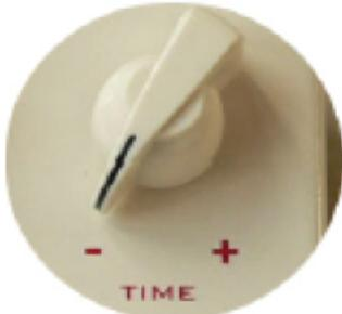
Lorsque la fonction MANUAL est active, réglez la durée du delay avec le bouton de réglage de type « chicken head ».
