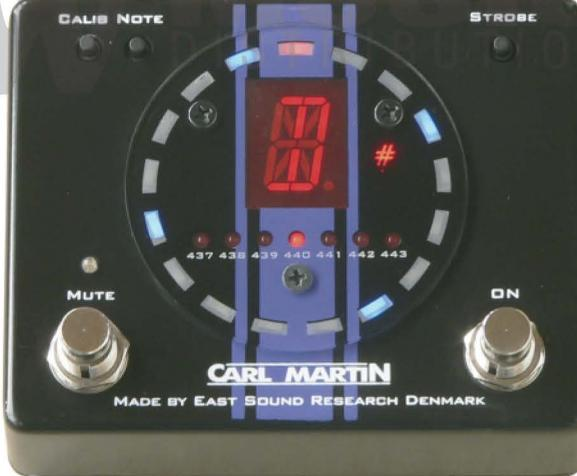
**Calib** – Die sieben LEDs auf der Oberseite des Pedals stehen für sieben verschiedene Kalibrierungen, die sich durch Drücken des Calib-Schalters anwählen lassen. Die Kalibrierungs-Einstellungen des Tuners reichen von 437 bis 443 Hz, wobei der Standardwert bei 440 Hz liegt. Trennt man die Stromversorgung, wird die Kalibrierungs-Einstellung auf 440 Hz zurückgesetzt.
