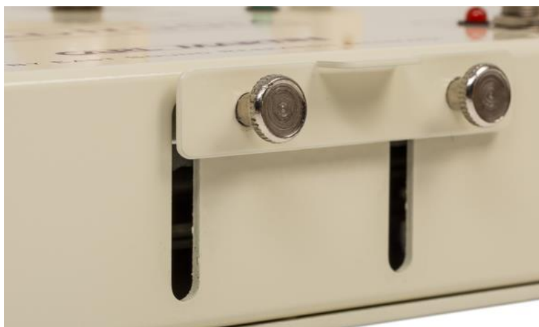
In dieser Position der Transportsicherung können die Federn frei schwingen
