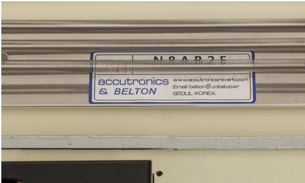
Drei Accutronics Hallspiralen generieren den Raumklang
