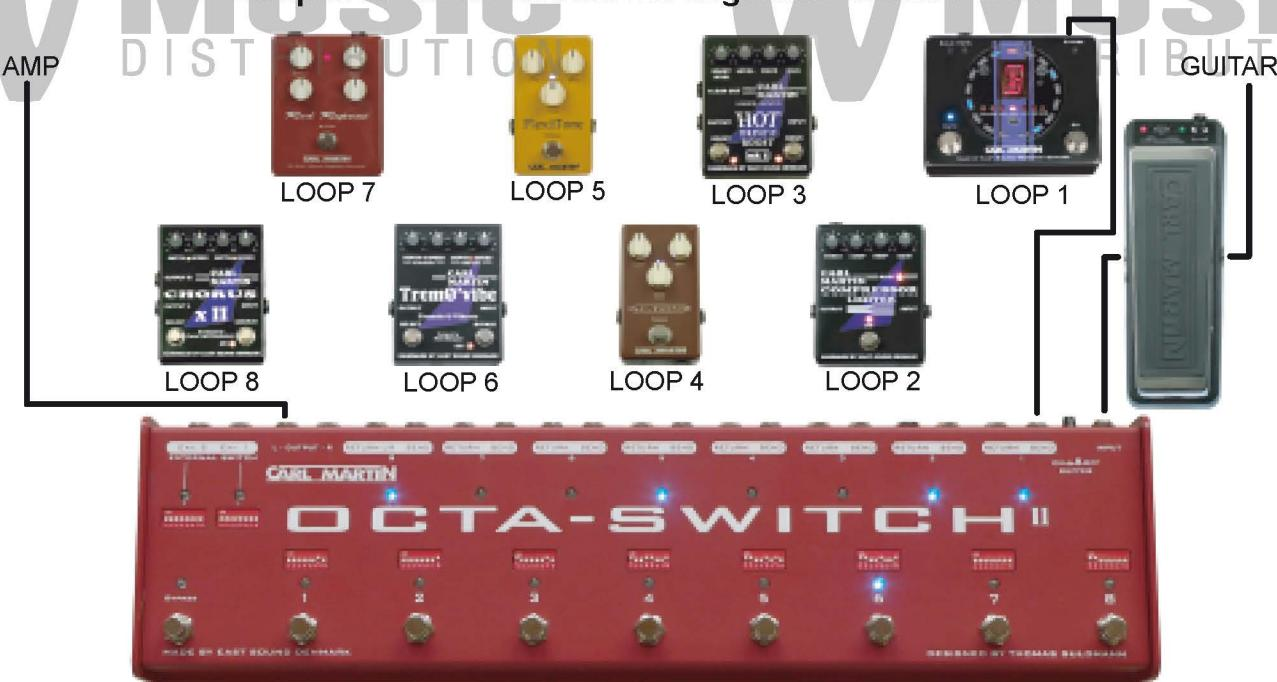
Verbinde einen Tuner z.B. mit dem Send von Loop 1, während der Return frei bleibt. Wenn du nun z.B. Bank 8 anwählst, bei der du nur Loop 1 aktiviert hast, ist dein ganzes System gemutet, während du mit dem Tuner dein Instrument stimmen kannst.
