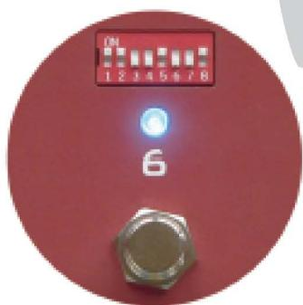
Anschließend kannst du sie anhand der nummerierten DIP-Schalter über den Bank-Fußtastern an- oder abwählen. Du bestimmst, welche Effekte auf welcher Bank aktiv sind. Zu jedem Effektloop und jeder Bank gehört jeweils eine blaue LED, sodass du immer im Blick hast, welche Bank mit welchen Effektwegen aktiviert ist. Sobald du alle Bänke programmiert hast, empfehlen wir dir, ein Stück Tesaband zum Schutz über die DIPs zu kleben.
