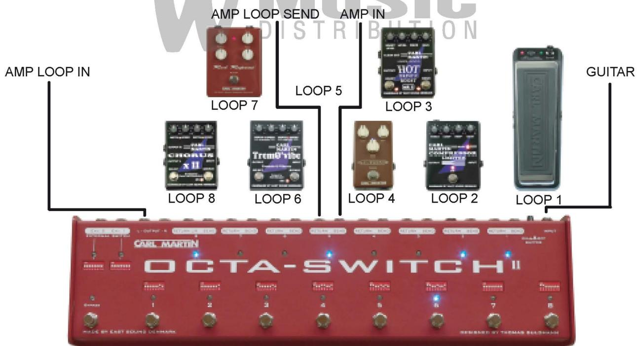
Wie in der Abbildung zu sehen, haben wir hier vier Pedale, die mit dem Input des Verstärkers verbunden sind und drei, die im Loop des Amps eingeschliffen werden.
