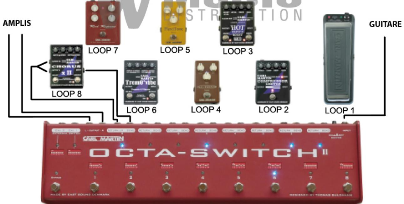
Utilisez un câble en Y de la sortie stéréo à la boucle return 8 :
