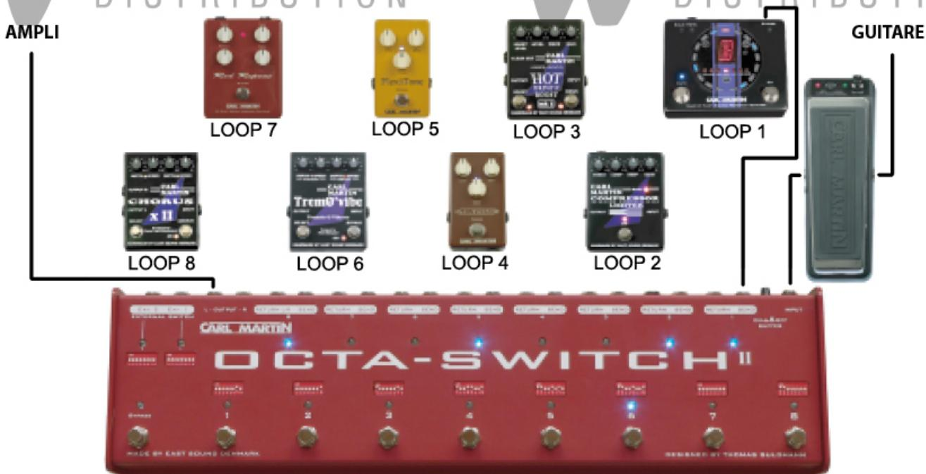
Connectez l'accordeur à la boucle 1 (par exemple) et ne reliez rien à la boucle de retour. Sélectionnez un programme dans lequel la boucle 1 est activée. De cette façon, vous coupez le son du système en faisant passer votre signal à travers l'accordeur.
