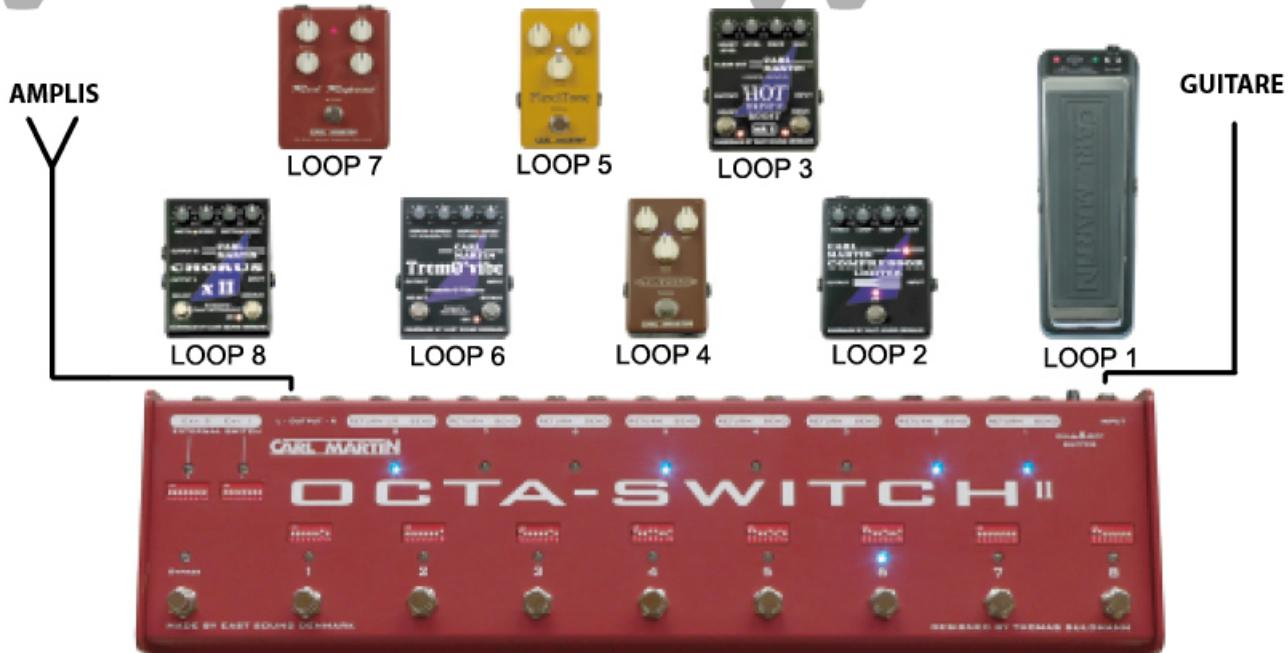
Utilisez un câble en Y à la sortie gauche avec 2 jacks mono et un jack stéréo.
