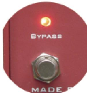
L'Octa-Switch dispose de neuf footswitches : les huit premiers sont des presets et le neuvième est un switch true bypass qui désactive l'appareil pour obtenir le son clair. Attention : si le buffer est activé, il sera également activé en mode bypass. Nous recommandons de le laisser activé lorsque vous êtes sur scène afin d'éviter les pertes d'aigus générées par les longueurs de câble.
