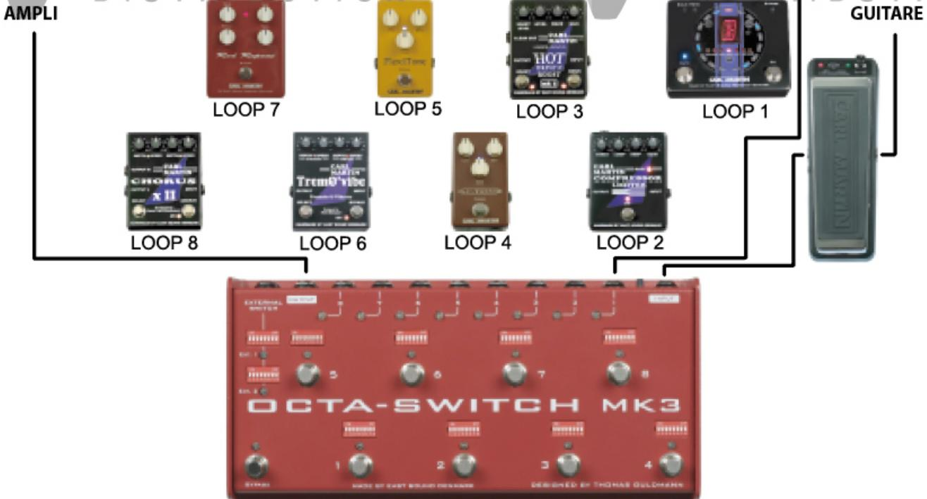
Connectez l'accordeur à la boucle 1 (par exemple) et ne reliez rien à la boucle de retour. Sélectionnez un programme dans lequel la boucle 1 est activée. De cette façon, vous coupez le son du système en faisant passer votre signal à travers l'accordeur.
