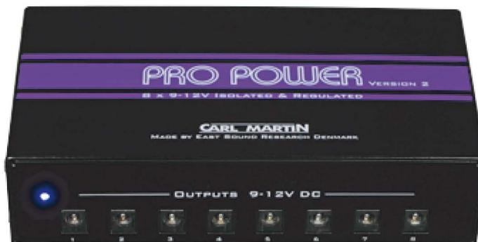
Das fängt schon beim schaltbaren (110-230V), gesicherten AC-Input an, der auf acht einzeln isolierte 9V-12V-Outputs (150 mA) verteilt wird, wobei die Outputs 7 und 8 eine erweiterte Leistung von 9V bei 350 mA und 12V bei 300 mA besitzen. Damit hat man eine perfekte Stromversorgung, die man praktisch in jedem Kontext verwenden kann. Über den DIP-Schalter auf der Rückseite des Pro Power lässt sich für jeden Output die Ausgangsspannung von 9V oder 12V anwählen.
