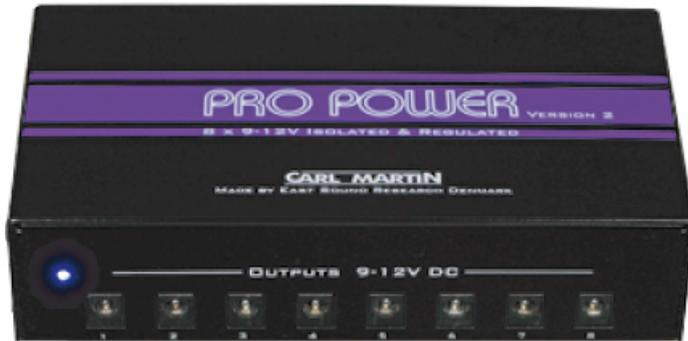
Son entrée CA switchable (110-230 V) alimente huit sorties isolées et stabilisées en 9 V (150 mA) - 12 V (150 mA). Les entrées 7 et 8 génèrent plus de puissance avec 9 V (350 mA) - 12 V (300 mA). Vous disposez alors d'une alimentation universelle que vous pouvez utiliser quasiment partout. Un simple switch DIP à l'arrière de l'appareil permet d'opter pour une tension de 9 V ou 12 V pour chaque sortie.
