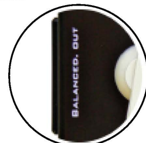
XLR-Output (200 Ohm) für Direct-Recording oder die Verwendung über eine PA. Zu beachten ist, dass AUX-Input und Master-Regler deaktiviert sind, wenn du diesen Output verwendest. In diesem Mode sind nur der Guitar-Input und die Amp/Speaker-Simulation aktiviert. Die Lautstärke wird dann über den Guitar-Regler eingestellt. Achte darauf, den Input des Mischpults nicht zu übersteuern.
