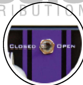
Mit dem Speaker-Simulation-Kippschalter kannst du zwischen offenen und geschlossenen Cabinets wählen
