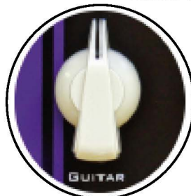
Der Guitar-Regler bestimmt die Lautstärke deiner Gitarre, wenn du den XLR-Ausgang benutzt. Gehst du über den Klinkenausgang, regelst du mit Guitar die Lautstärke deines Instruments im Verhältnis zum Master-Level.
