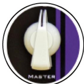
Utilisez le master pour régler niveau de sortie général et le niveau AUX lorsque vous utilisez la prise de sortie jack 1/4" asymétrique ou un casque.
