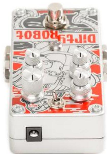
*Auf der Stirnseite befindet sich leicht versetzt die 9V-Buchse.*
