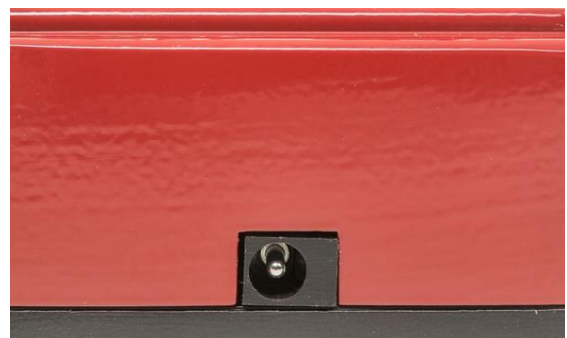
...der Anschluss für ein externes Netzteil
