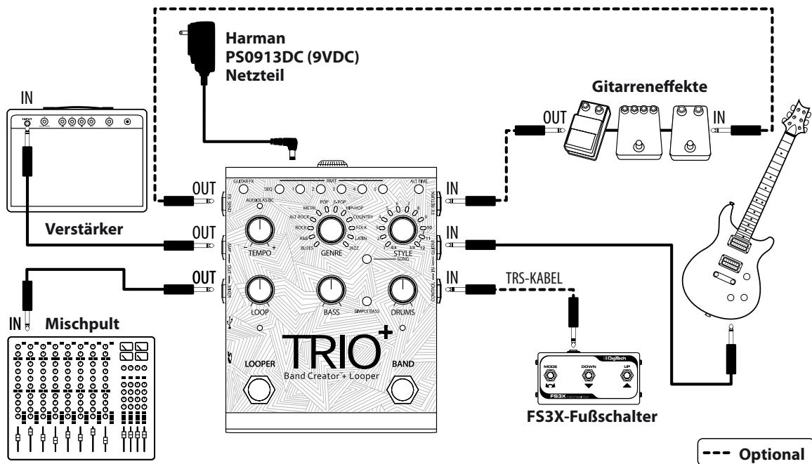
Verwenden Sie für Audioverbindungen ausschließlich unsymmetrische TS-Instrumentenkabel.
