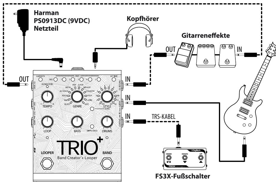
Verwenden Sie für Audioverbindungen ausschließlich unsymmetrische TS-Instrumentenkabel.
