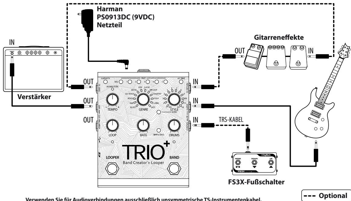
**HINWEIS:** Bei der Verwendung des AMP OUT werden Drums und Bass mit einer umgekehrten Cabinet-Simulation wiedergegeben. Siehe auch „*Funktionsweisen der Ausgangsbuchsen*“ auf Seite 15.
