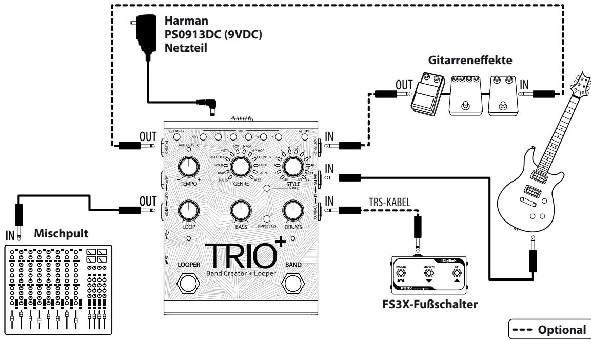
**HINWEIS:** Wenn nur der MIXER OUT verwendet wird, wird das Gitarrensignal mit einer zusätzlichen Cabinet-Simulation wiedergegeben. Siehe auch „*Funktionsweisen der Ausgangsbuchsen*“ auf Seite 15.
