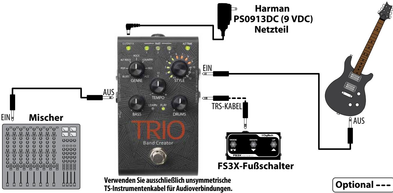
**HINWEIS:** Wenn nur die MIXER OUT-Buchse verwendet wird, wird die Lautsprecherboxemulation dem Gitarrensignal hinzugefügt. Weitere Informationen finden Sie unter „*Betrieb der Ausgangsbuchse auf Seite 9*“.
