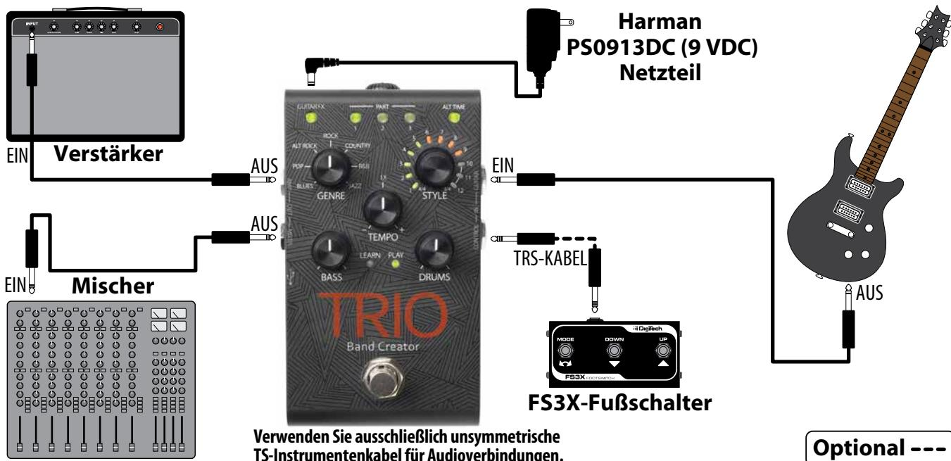
**HINWEIS:** Beim Anschluss an die MIXER- und AMP OUT-Buchsen wird das Gitarrensignal an den AMP-Ausgang gelegt und werden die Bass- und Schlagzeugteile an den MIXER-Ausgang geleitet. Weitere Informationen finden Sie unter „*Betrieb der Ausgangsbuchse*“ auf Seite 9.
