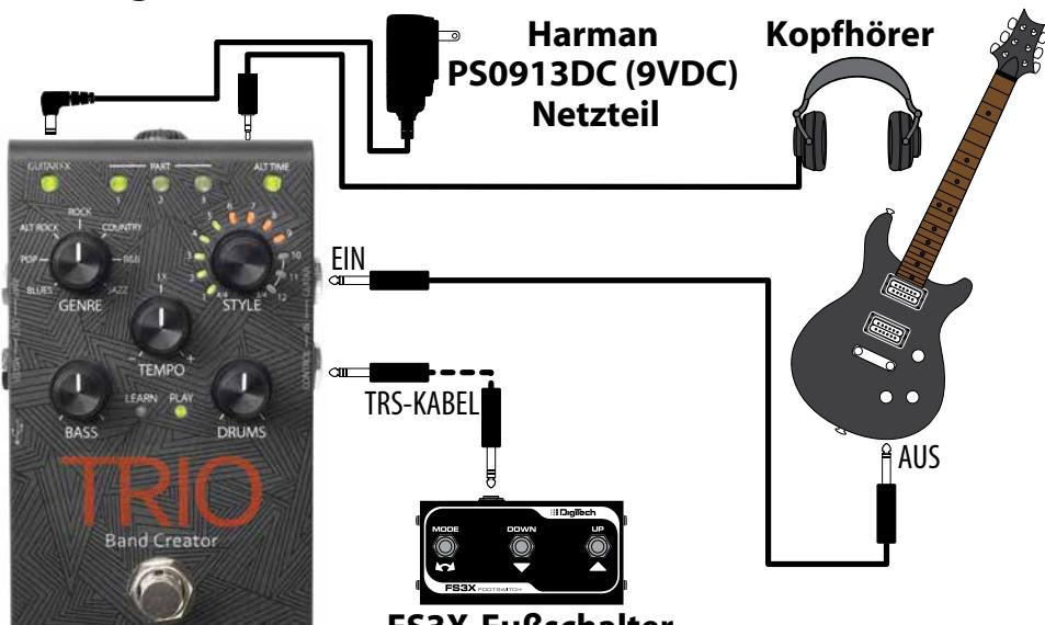
**HINWEIS:** Wenn die Kopfhörerausgangsbuchse verwendet wird, werden die AMP- und MIXER-Ausgänge stummgeschaltet. Das im Kopfhörer anliegende Signal wird ein Stereosignal sein und die Lautsprecherboxemulation wird auf das Gitarrensignal angewendet. Weitere Informationen finden Sie unter „*Betrieb der Ausgangsbuchse*“ auf Seite 9.
