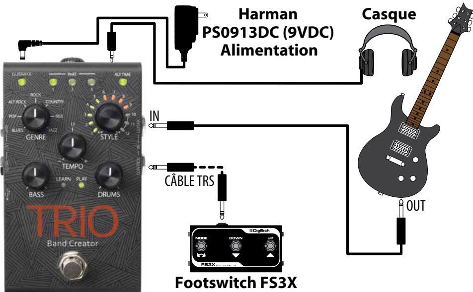
**REMARQUE :** Lorsque le jack HEADPHONE OUT est utilisé, les sorties AMP et MIXER seront mises en sourdine. Le signal présent dans le casque sera en stéréo et la fonctionnalité Speaker Cabinet Emulation sera appliquée au signal guitare. Voir '*Fonctionnement du jack de sortie*' page 9 pour de plus amples détails.
