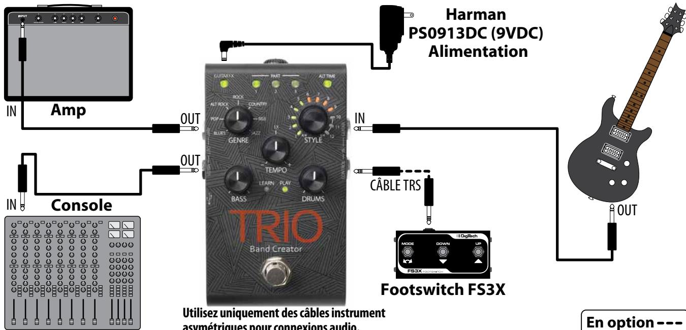
**REMARQUE :** Lorsqu'il est connecté à la fois au jack MIXER et AMP OUT, le signal guitare sera diffusé dans la sortie AMP et les parties de basse et de batterie seront diffusées dans la sortie MIXER. Voir '*Fonctionnement du jack de sortie*' page 9 pour de plus amples détails.
