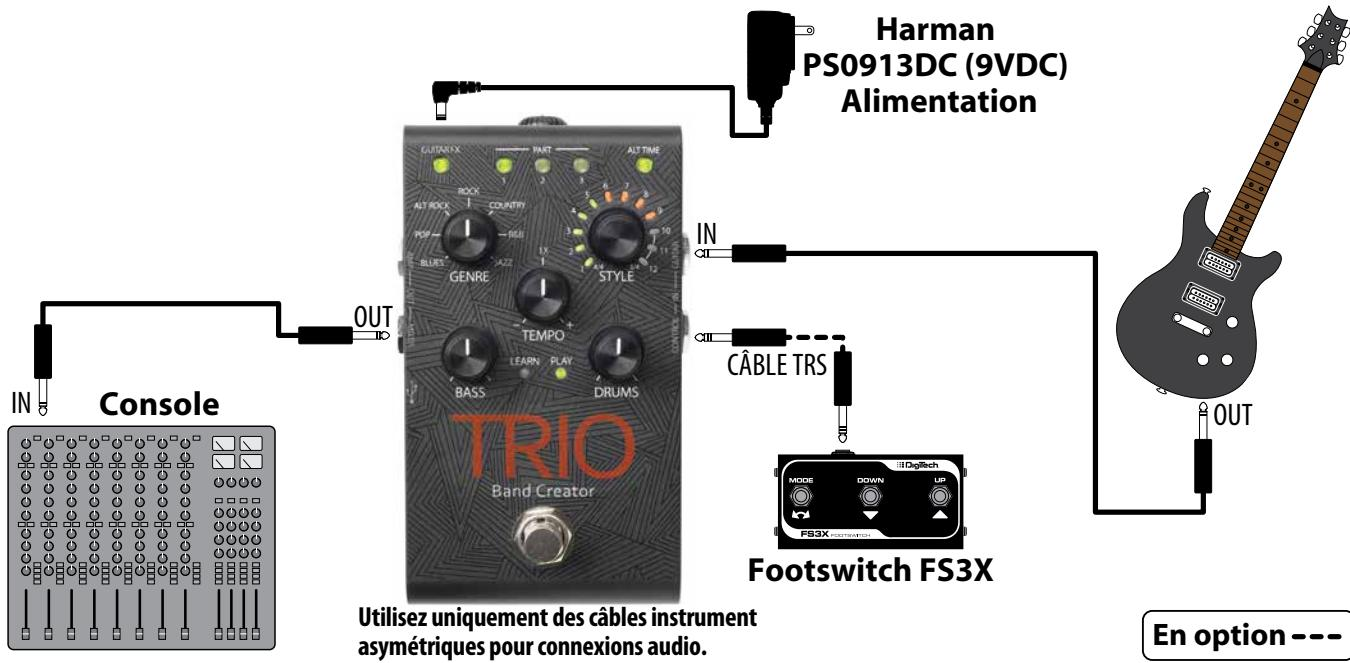
**REMARQUE :** Lorsque seul le jack MIXER OUT est utilisé, la fonction Speaker Cabinet Emulation est ajoutée au signal guitare. Voir '*Fonctionnement du jack de sortie*' page 9 pour de plus amples détails.
