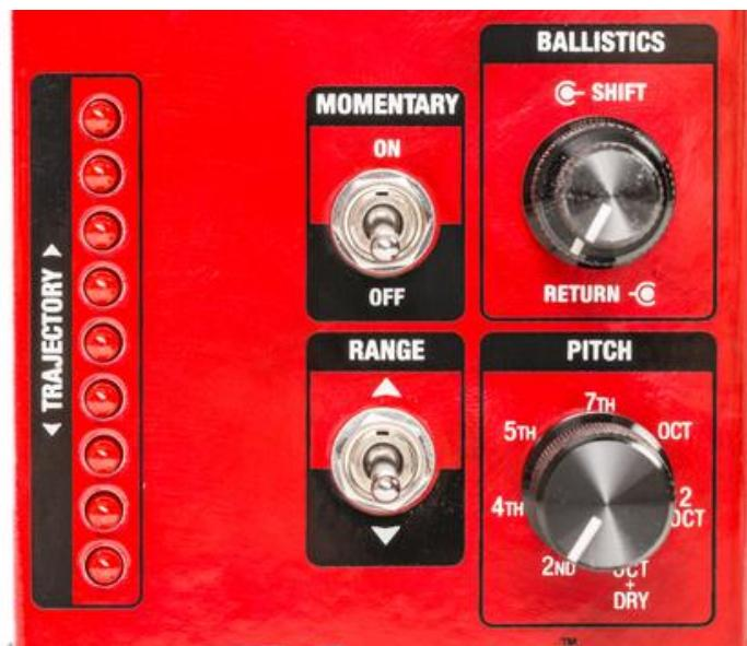
...ein Rasterpoti für den Pitch-Shift-Mode, zwei Mini-Kippschalter und eine LED-Kette.
